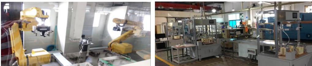
东岩压铸新投入的机器人去毛刺设备
