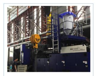
2018 年 6 月公司新增海天高速注塑机一台,主要用于生产托盘(卡板),生产效率将提高一倍,预计年产值 1200 万元。
